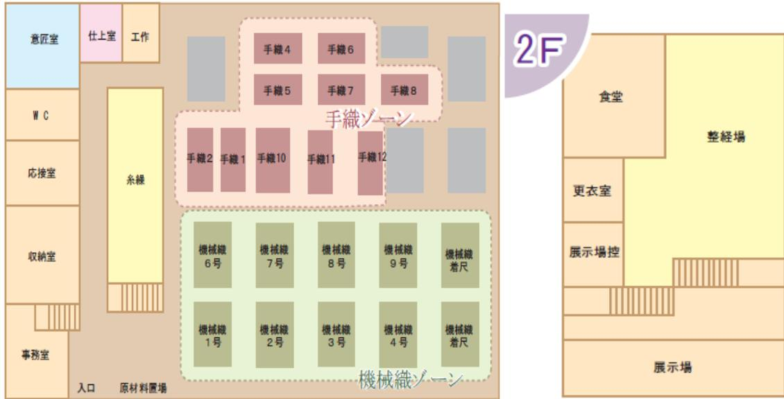
工場内には、手織り、機械織り合わせて 20 台の機（はた）を保有しております。機を変えることで、一人の職人が数種類の帯を製造することが可能です。特に、手織りの機を数多く保有し稼働させていることが当社工場の特徴であると考えております。
